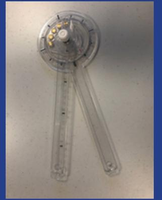
Il y a également le **goniomètre adapté avec son fil à plomb intégré**. Il se lit grâce aux graduations en braille. Le fil à plomb est remplacé par les 5 ronds métalliques dorés situés autour du centre du goniomètre, la verticale est représentée par le rond doré du milieu. Les autres ronds sont là afin d'apporter du poids pour faire en sorte que cela soit entraîné vers le bas.
