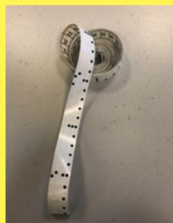
Il existe le **mètre ruban adapté en braille** et le **sparadrap** qui grâce à son relief permet de remplacer le crayon dermographique pour les cours d'anatomie palpatoire.
